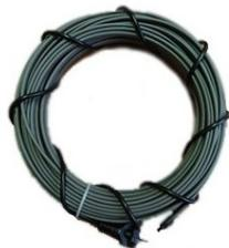
Саморегулирующийся нагревательный двухжильный кабель основан на эффекте зависимости сопротивления полупроводниковой матрицы от температуры.
