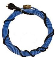
Саморегулирующийся нагревательный двухжильный кабель основан на эффекте зависимости сопротивления полупроводниковой матрицы от температуры. Основной отличительной особенностью модели
