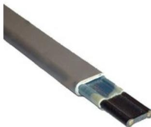
Основной отличительной особенностью модели 24ASH2 является оболочка из полиолефина, благодаря которой кабель становится пожаростойким. Так же, как и другие саморегулирующиеся греющие кабели, 24ASH2 не боится локального перегрева при намотке внахлест.
