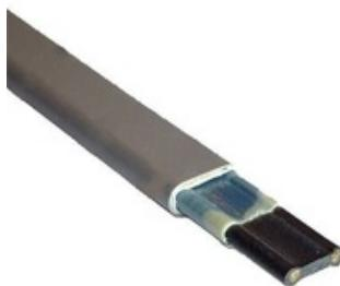
Основной отличительной особенностью модели 16ASH2 является оболочка из полиолефина, благодаря которой кабель становится пожаростойким. Так же, как и другие саморегулирующиеся греющие кабели, 16ASH2 не боится локального перегрева при намотке внахлест.
